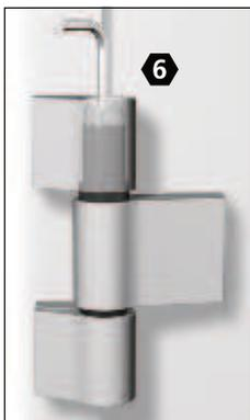
4. Lagerbuchse um  $\pm 90^\circ$  drehen bis sie spürbar einrastet (Dichtungsdruck  $\pm 0,5$  mm)
